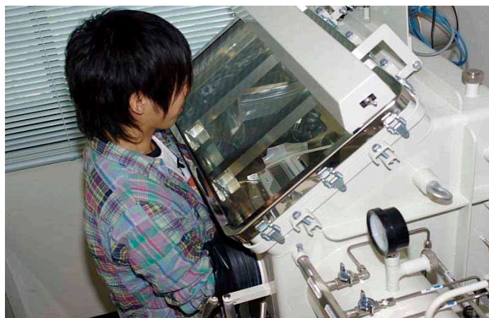
グローブボックス内での電池作製とセラミックス焼成実験 Construction of lithium-ion batteries in a glove box (left) and ceramics-sintering experiments (right)
