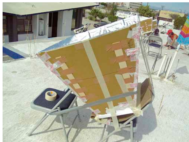
簡易な集光装置による太陽電池の発電出力向上の実証実験 (メキシコ合衆国ラパス市にて) Improvement of power output of PV module with inexpensive portable sunlight concentrator -Demonstration experiment in La Paz, Mexico-
