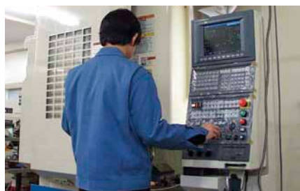
高速マシニングセンタによる高精度曲面加工 High precision milling of sculptured surface by machining center with high speed spindle
