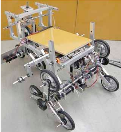
段差昇降可能な車椅子のモーションコントロール Motion Control of Stair Climbing Wheelchair
