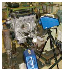
エンジンの潤滑油膜可視化 Visualization of lubrication oil film
