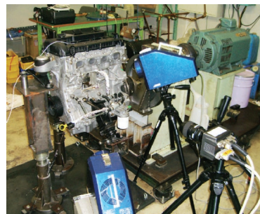
エンジンの潤滑油膜可視化 Visualization of lubrication oil film
