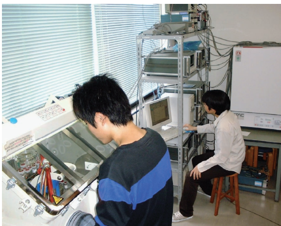
グローブボックス内での電池作製と充放電実験 Construction of lithium-ion batteries in a glove box and charge-discharge experiments.
