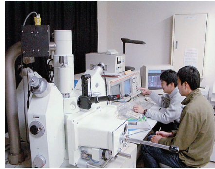
SEM-EPMA によるナノ観察、マイクロ分析 Microstructure analysis using SEM-EPMA system.
