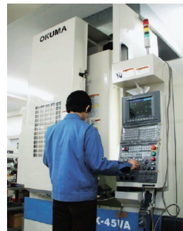
高速マシニングセンタによる 高精度曲面加工 High precision milling of sculptured surface by machining center with high speed spindle
